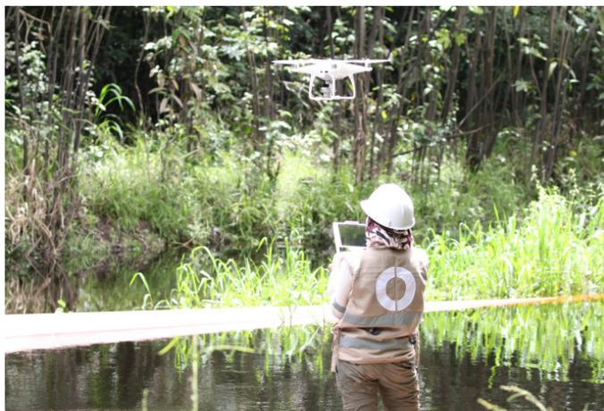
Imagen 1. Captura de imágenes utilizando drones en zonas de trabajo con acceso limitado.
