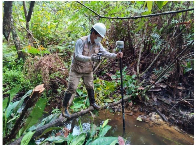
Imagen 2. Localización de puntos de control terrestre para la captura de datos utilizando drones.
