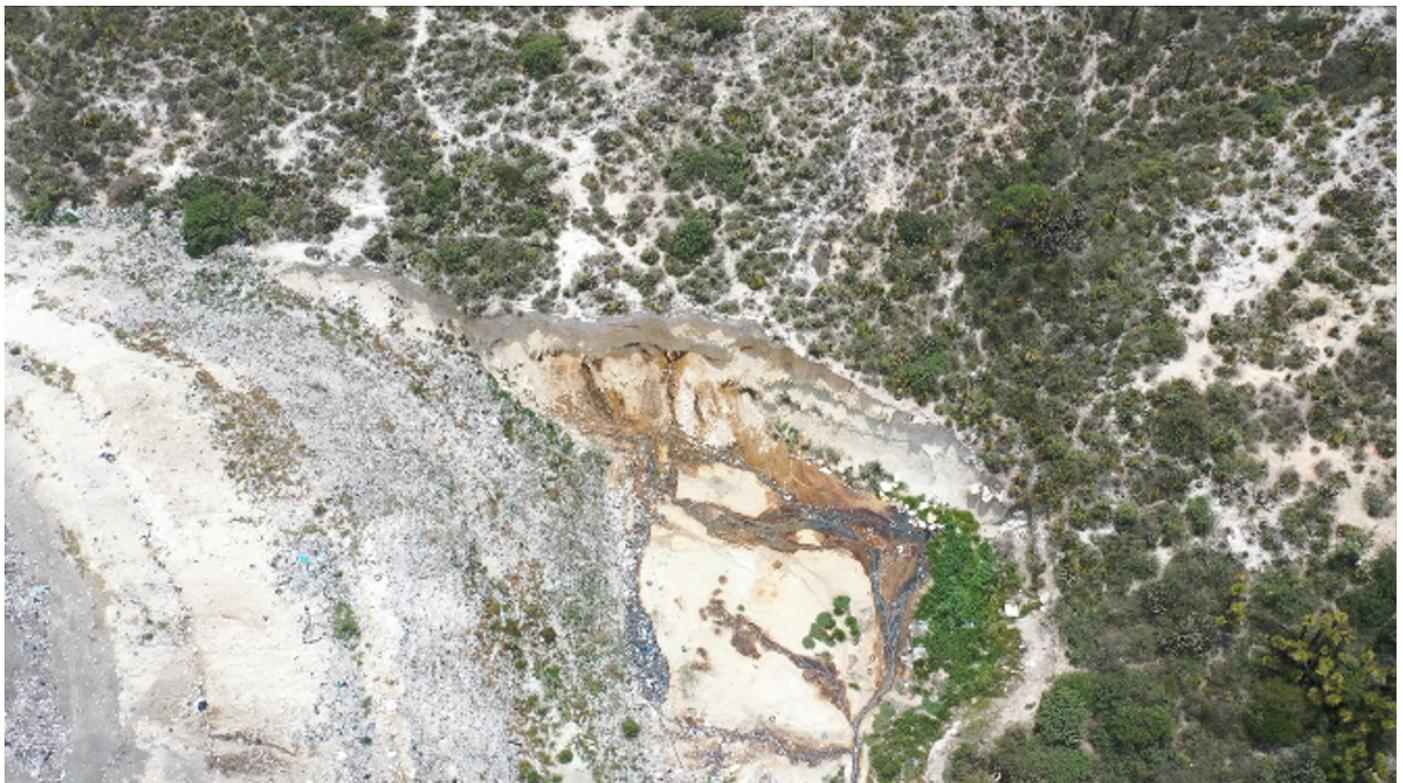
Imagen 3. Esguerrimiento de lixiviados en un relleno sanitario inspeccionado (2023).
