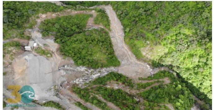
Imagen 2. Derrame de una sustancia proveniente de la presa de jales de una instalación minera (2022).
